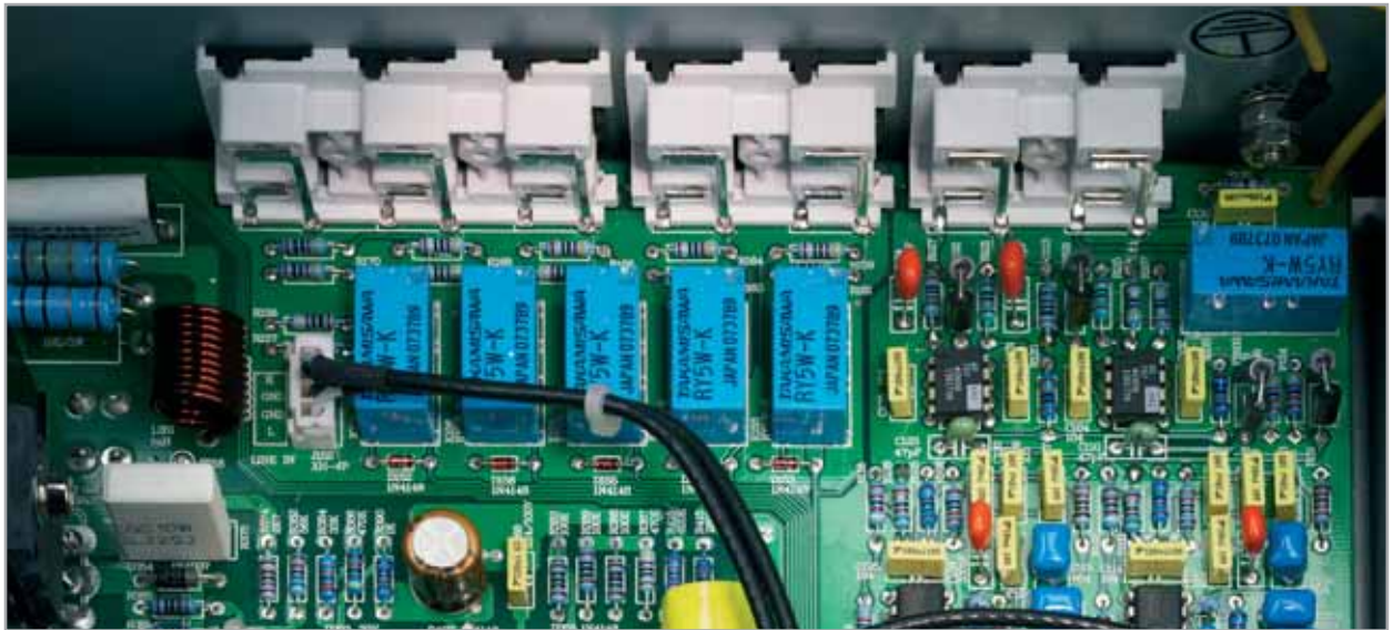
MM/MC-Phonovorstufe mit rauscharmen Operationsverstärkern/ MM/MC phono pre-amplifier with low-noise operational amplifiers
