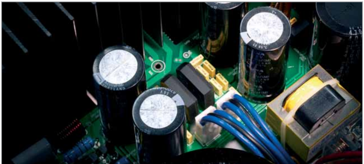
Kanalgetrennte Spannungsversorgungen / Sophisticated Dual Mono power supplies
