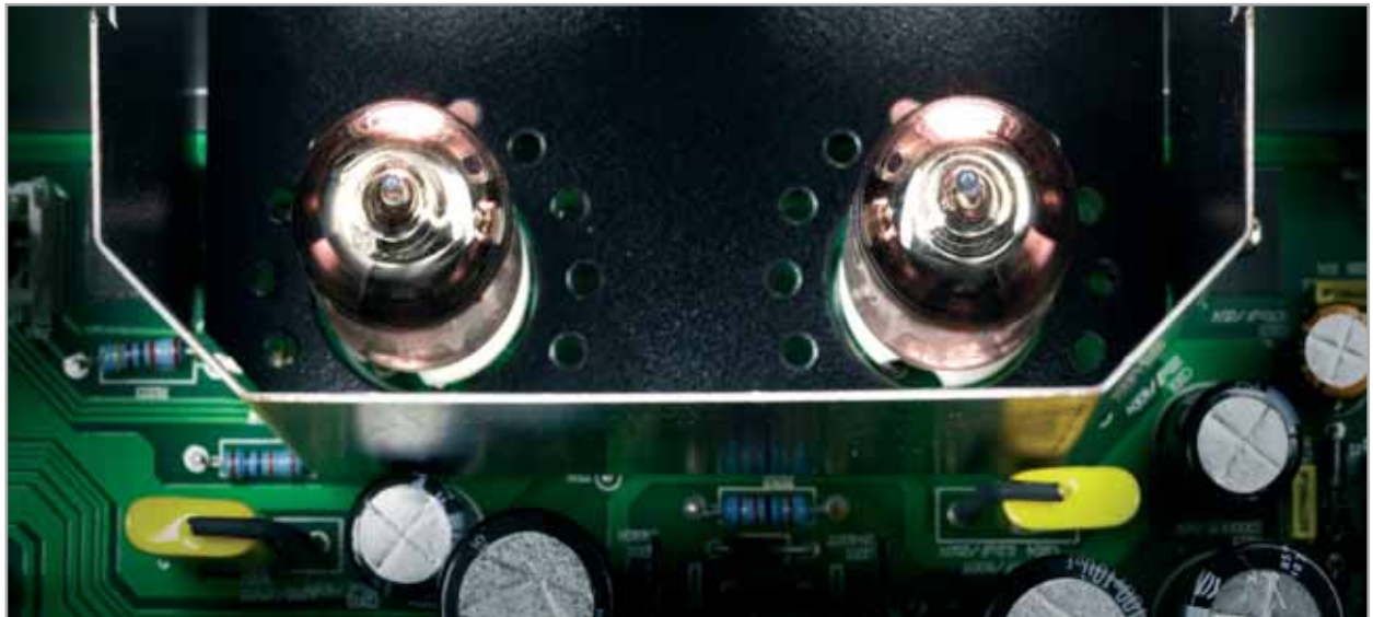
Eingebrante (60 Std.) und selektierte Röhren aus russischer Produktion / Carefully selected and 'burnt-in' (60 hours) valves from Russia
