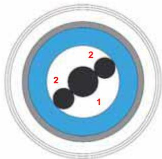
*Внутренняя конструкция симметричного (справа) и несимметричного (слева) кабеля различается главным образом по числу и диаметру проводников. Центральный «плюсовый» проводник (1) отделен от диэлектрика (3) фторопластовыми разделителями (2). Наполнитель (4) XLR версии не несет проводящей функции.*
